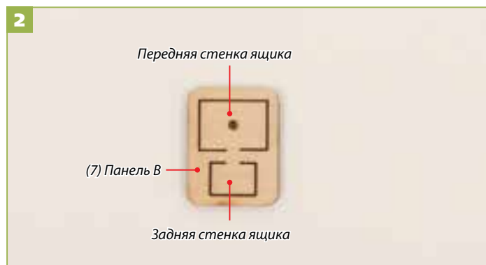
2 Аналогичным образом отделите от панели В переднюю и заднюю стенки ящика.
