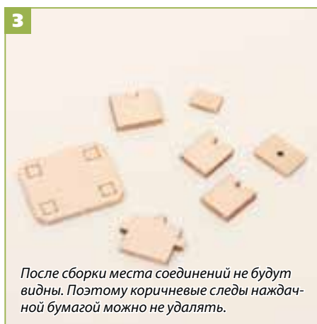
3 Обработайте наждачной бумагой края деталей, отделенных в шагах 1–2.
