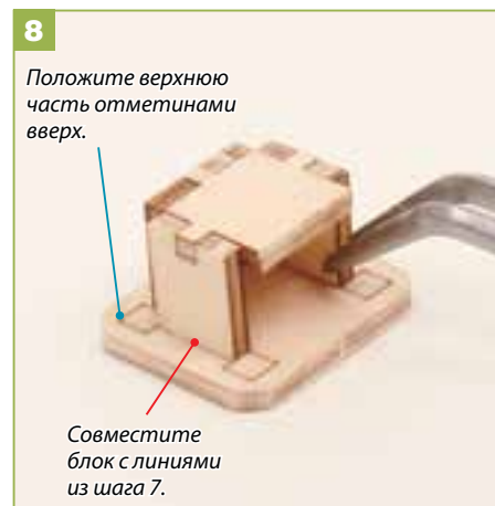
8 Приклейте блок, собранный в шаге 6, к верхней части по линиям из шага 7.
